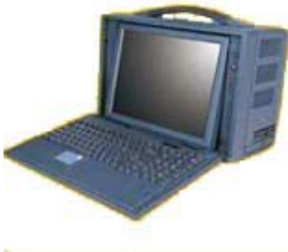
PPC-1800 采用双层结构，机箱外壳采用增强 ABS 工程塑料制成，里面有一个铝合金内壳。所有板卡及驱动器呈水平防置，最大能插入 9 个全长各类板卡。三个强力推拉风扇在板间形成风流，机箱内部散热优异。为了提高系统稳定性，机箱配有紧固所有板卡的防震压条。
